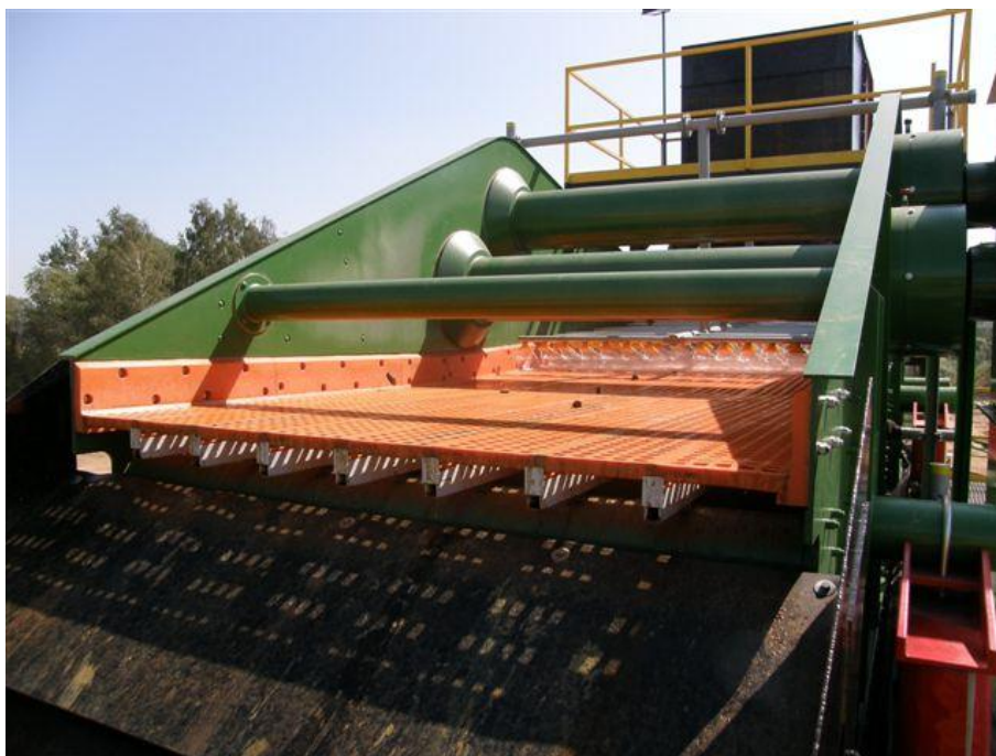
Rycina 5. Przesiewacz z sitami poliuretanowymi tłumiącymi hałas ( fot. archiwum SKSM )
